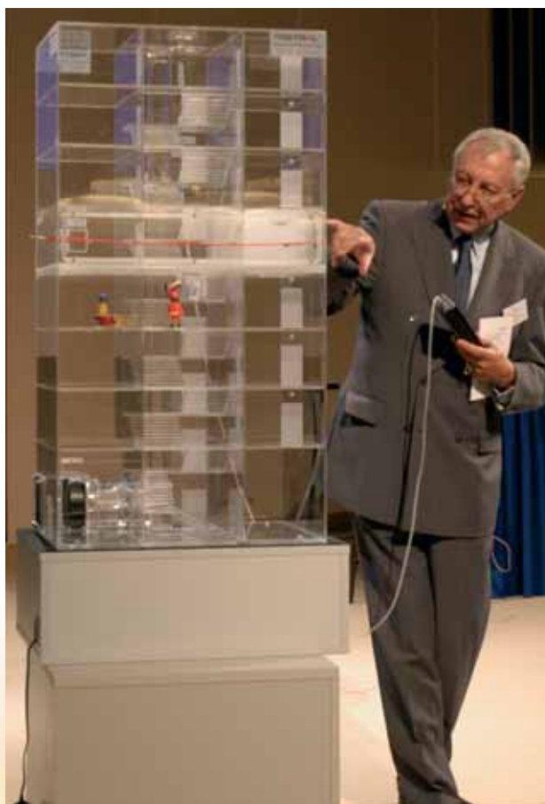
Professor Ermer demonstriert an seinem Gebäudemodell die Wirksamkeit seines Rauchvermeidungssystems
